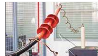
Высоковольтные испытания кабельных муфт
