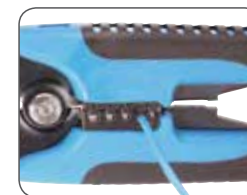
Опрессовка наконечника НШВ
