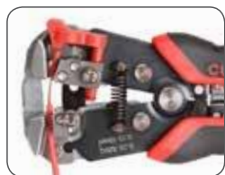
Снятие изоляции с проводов
