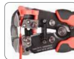
Снятие изоляции с проводов
