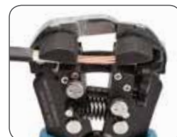
Одновременное снятие изоляции с трех проводов
