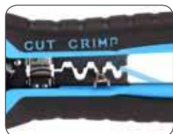
Опрессовка неизолированного наконечника
