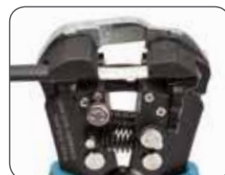
Снятие оболочки многожильного провода
