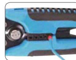
Опрессовка наконечника НШВИ
