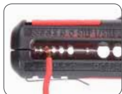
Снятие изоляции с проводов
