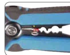
Опрессовка изолированного наконечника
