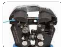
Снятие изоляции с микропровода
