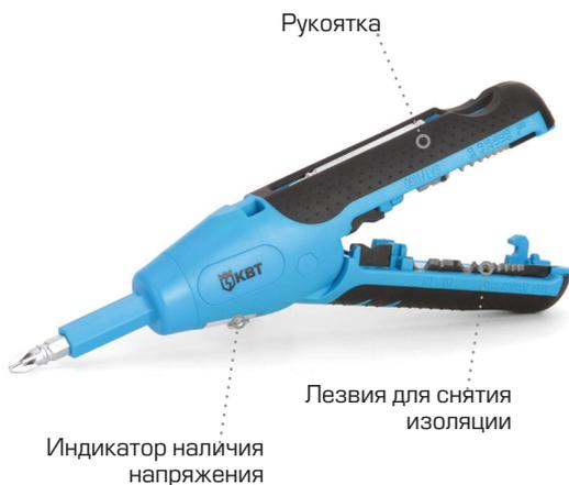
Ручной стриппер WS-05 состоит из двухкомпонентной, раскрывающейся рукоятки, многопозиционных лезвий для резки и разделки кабеля/провода, наконечника для установки отверточных бит и индикатора наличия напряжения в сети
