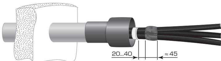
**3.2.2** С усилием сжать герметизируемые кабели вместе, наложить бандаж из киперной ленты, как показано на рисунке. Другой частью герметика заполнить пустоты между кабелями по наружной поверхности.
