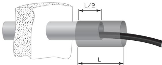
**2.1** Термоусаживаемую манжету расположить симметрично относительно края трубы кабельного прохода таким образом, чтобы середина манжеты совпала с торцом трубы.
