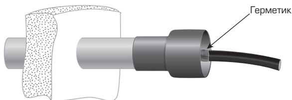
**3.1.2** Кабель расположить относительно трубы так, чтобы он находился как можно ближе к центру трубы кабельного прохода (наружной оболочкой кабель не должен касаться внутренней поверхности трубы). Зафиксировать кабель в таком положении.
