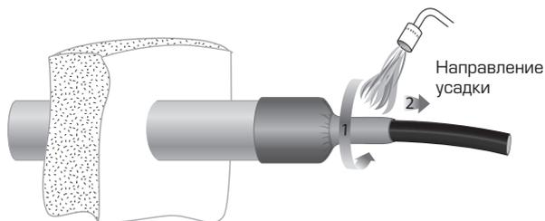
**3.1.3** Усадить манжету на кабель в направлении от трубы. Произвести подсыпку грунта под кабель во избежание перегиба уплотнителя в месте выхода кабеля из трубы. Необходимо дождаться полного остывания манжеты, после чего можно дальше работать с кабелем.
