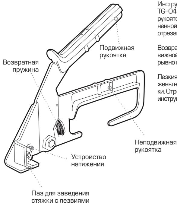
Инструмент для монтажа нейлоновых стяжек TG-04 состоит из подвижной и неподвижной рукояток, устройства натяжения с подпружиненной зубчатой собачкой и лезвиями для отрезания стяжки.
