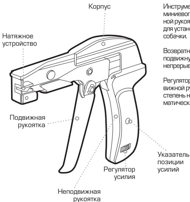
Инструмент TG-01 состоит из легкого алюминиевого корпуса, подвижной и неподвижной рукоятки, натяжного устройства с пазом для установки стяжки и подвижной зубчатой собачки.
