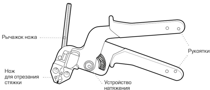
Инструмент для монтажа стальных стяжек TG-02 состоит из подвижной и неподвижной прорезиненных рукояток, направляющего устройства с пазом для размещения стяжки, устройства натяжения с подпружиненной зубчатой собачкой и ножа для отрезания конца стяжки.
