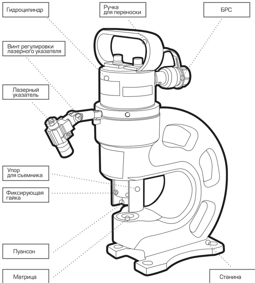
Прессы гидравлические **ШД-95 NEO (КВТ)**, **ШД-110 NEO (КВТ)** состоят из станины, в нижней части которой устанавливается матрица, фиксируемая винтом. Станина имеет отверстия для стационарного крепления прессы.
