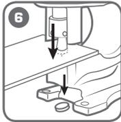
Создайте помпой давление в гидроцилиндре инструмента. Пробейте отверстие.
