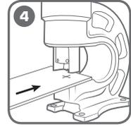
Установите шину между матрицей и пуансоном по месту пробиваемого отверстия.
