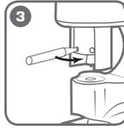
Зафиксируйте пуансон гайкой, используя вороток (ШД-95). Гайка ШД-110 затягивается от руки
