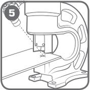
При помощи лазерного указателя установите центр пробиваемого отверстия.
