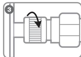
**3** Плотно затяните гайку БРС, приложив достаточное усилие (от руки) для обеспечения хорошего соединения (без применения слесарного инструмента)
