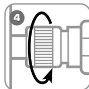
Плотно затяните гильзу БРС, приложив достаточное усилие (от руки) для обеспечения хорошего соединения (без применения слесарного инструмента)
