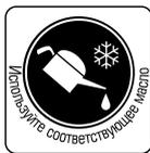
Во время подготовки инструмента к эксплуатации убедитесь, что используемое гидравлическое масло соответствует температуре окружающей среды в месте проведения работы. Проверьте наличие и уровень масла в резервуаре гидравлического насоса.
