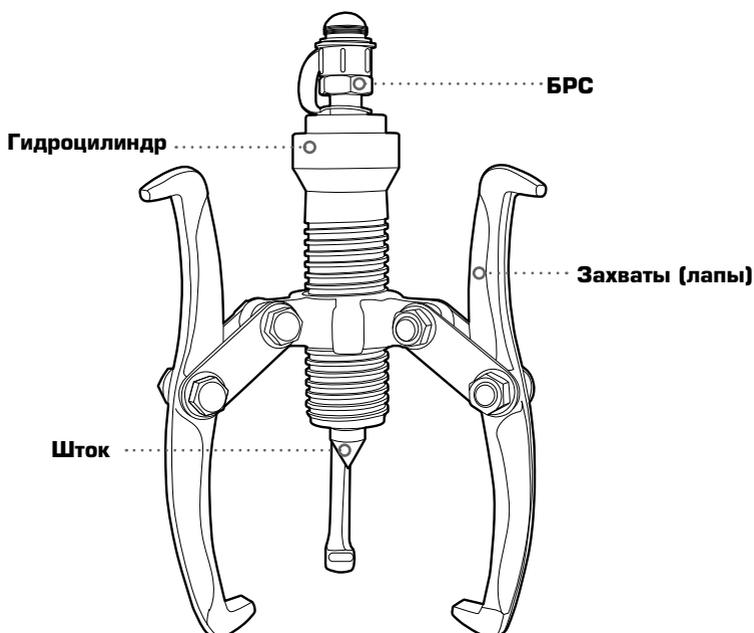
Съемник гидравлический состоит из корпуса гидроцилиндра, упорного штока, захватов (лап) и быстроразъемного соединения (БРС). Внешний насос подключается к съемнику с помощью рукава высокого давления через БРС. Подача рабочей жидкости в полость гидроцилиндра съемника под давлением происходит за счет приведения в работу внешнего гидравлического насоса.
