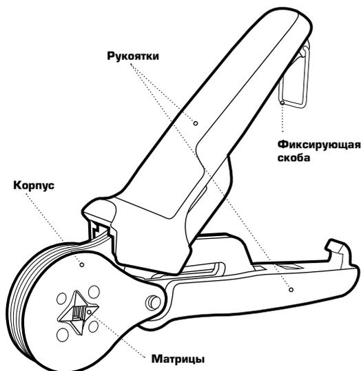
Пресс-клещи **ПКВк-10М (КВТ)** состоят из двухкомпонентных рукояток, корпуса, саморегулирующихся матриц и фиксирующей скобы.
