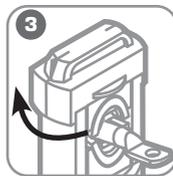
**Установите поверх изделия верхнюю матрицу, поворотную крышку до щелчка и создайте давление помпой**
