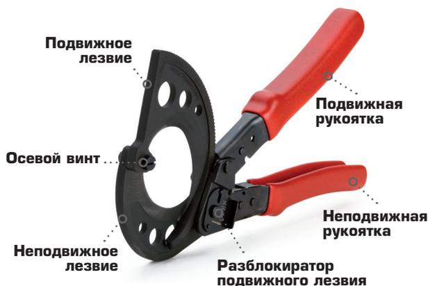
Ножницы секторные состоят из подвижного и неподвижного лезвия, подвижной и неподвижной рукоятки, храпового механизма
