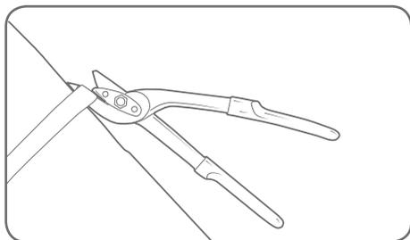
Установите ножницы на ленту, чтобы она оказалась между опорным лезвием и защитным упором.
