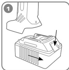
**1** Для снятия аккумулятора, нажмите на фиксатор и выньте его из корпуса инструмента.
