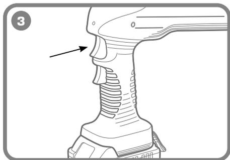
**Нажмите на кнопку «ПУСК» и держите нажатой ее до срабатывания механизма автоматического сброса давления. При этом раздается характерный щелчок.**
